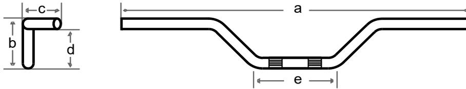
**Lenker aus Rohr 25,4 mm Ø (1"), mit Kerbe für Elektrokabel und 3Loch Kabelinnenführung (für alle HD ab Bj. 82)**
