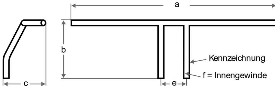
T-Bar Lenker mit Gewinde in den Steigrohren (Lochabstand 100 mm, für viele japanische Motorräder). Die Lenker werden mit einer Schraube von unten durch die Gabelbrücke angeschraubt. Für einige Motorradmodelle gibt es Montagekits, für andere Modelle muss die Montage, wie im Teilegutachten in der Anbauanleitung beschrieben, durchgeführt werden.
