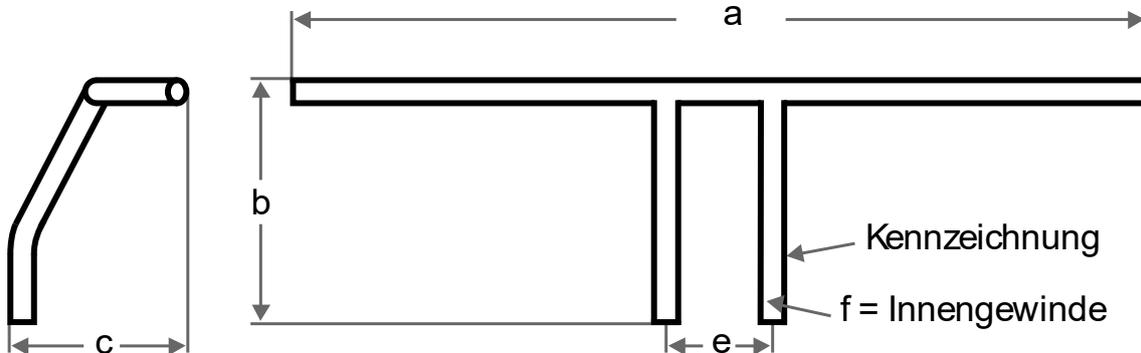
T-Bar Lenker mit Gewinde in den Steigrohren (Lochabstand 100 mm). Die Lenker werden mit einer Schraube auf der Gabelbrücke befestigt. Die Schraube wird von unten durch die Gabelbrücke in den Lenker geschraubt. Für einige Motorradmodelle gibt es Montagekits, für andere Modelle muss die Montage, wie im Teilegutachten in der Anbauanleitung beschrieben, durchgeführt werden.
